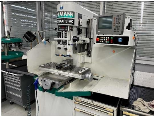
**Koordinaten-Bohrmaschine: Fehlmann Picomax 51 AC**
