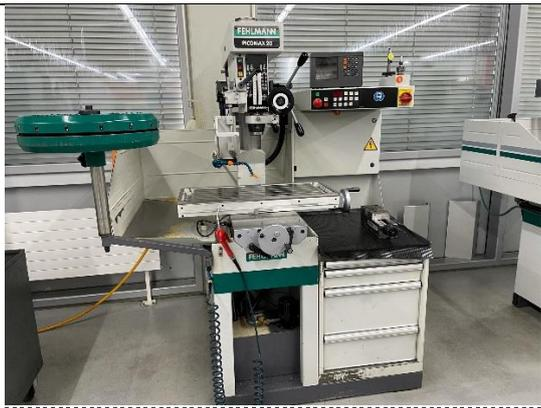
**2. Koordinaten-Bohrmaschine: Fehlmann Picomax 20**
